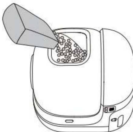
Asegúrese de que la cantidad de arena para gatos no supere la línea MAX. La longitud de la arena para gatos seleccionada debe ser inferior a 1.2 cm y el diámetro inferior a 3 mm
