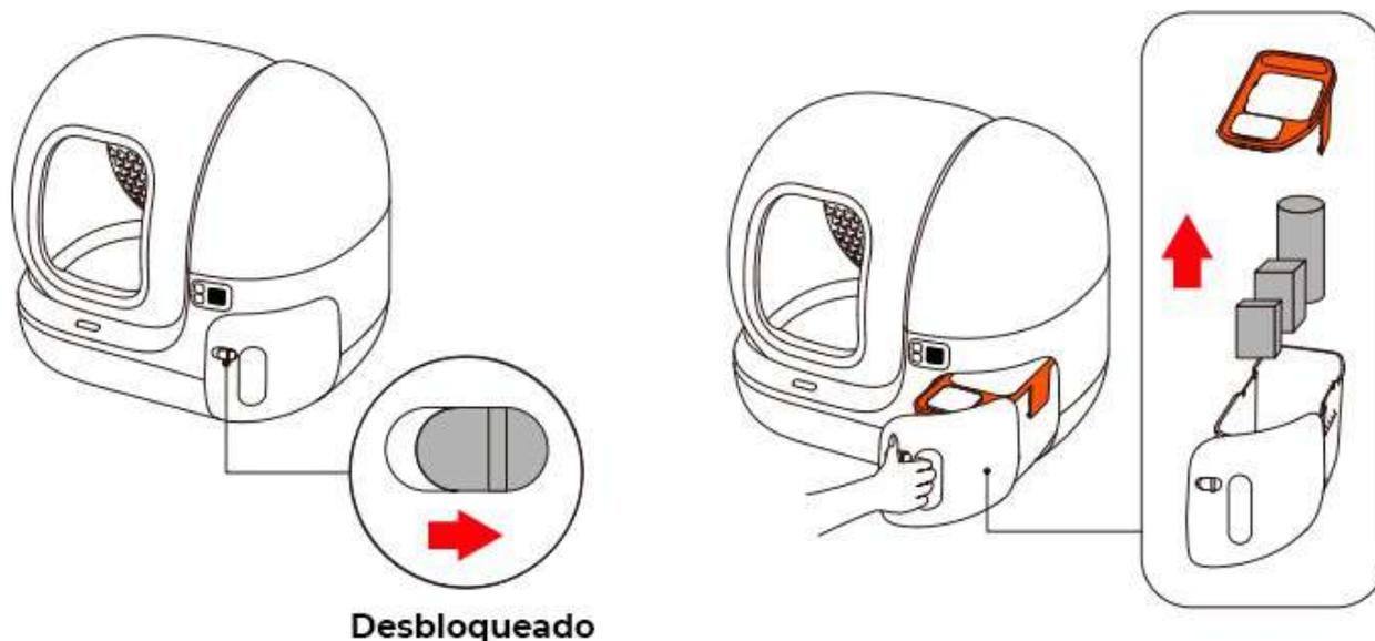
2. Extienda la bolsa de basura uniformemente y presiónela en el fondo del contenedor de residuos, y cierre la tapa del contenedor.
