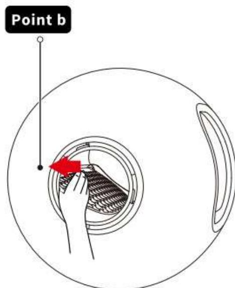
4. Si el tamiz puede agitarse de un lado a otro, la instalación se ha completado.
