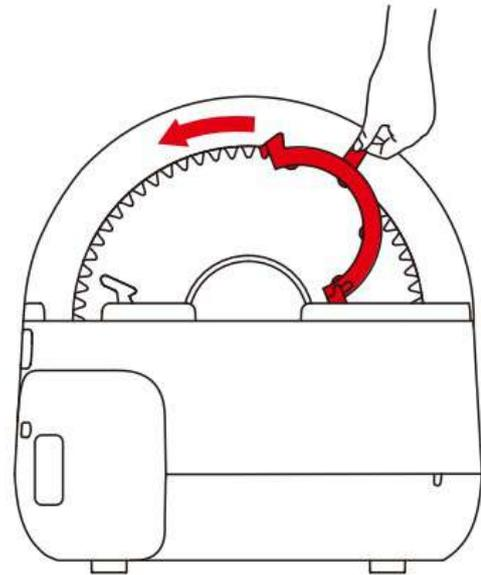
3. Atornille la tapa lateral y vuelva a instalar la tapa lateral magnética
